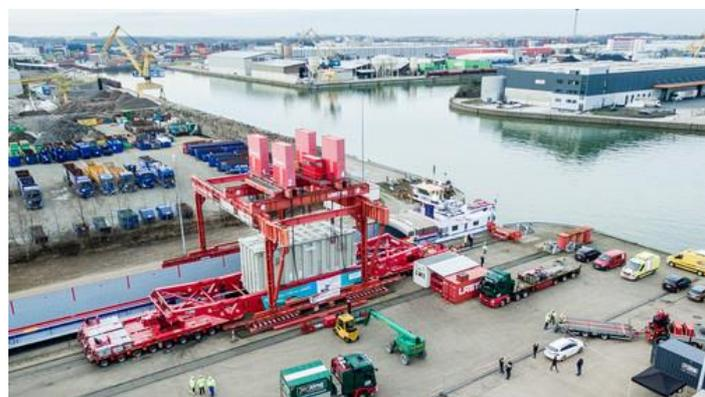
Verladung eines 535 to Siemens-Trafos von Nürnberg nach Nordchina
