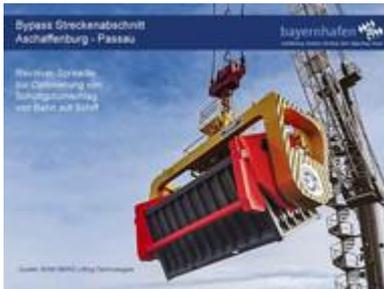
Beim Verladertag präsentierte bayernhafen einen neuen Ansatz zur Flexibilisierung der Schiffsladung bei Wasserstandsänderungen: Schüttcontainer, die automatisiert durch Horizontalrotation entleert werden können. Im Bild ein Revolver-Spreader von RAM SMAG zur Optimierung von Schüttgutumschlag von Bahn auf Schiff.
