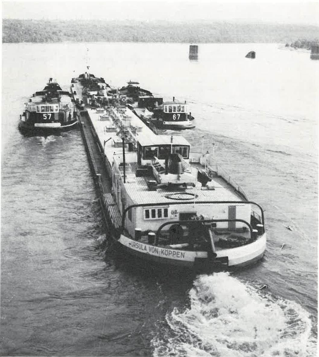
**13** Das Tankmotorschiff „Ursula von Köppen“ (Baujahr 1970, 1350 PS) auf der Bergfahrt bei Novi-Sad (Jugoslawien) mit einem Tankschubleichter und 2 Tankkähnen in Schubformation.
